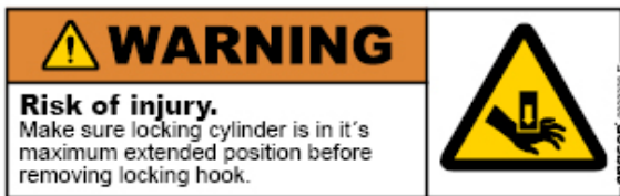
Afbeelding22. Waarschuingssticker op vergrendelcilinder.
